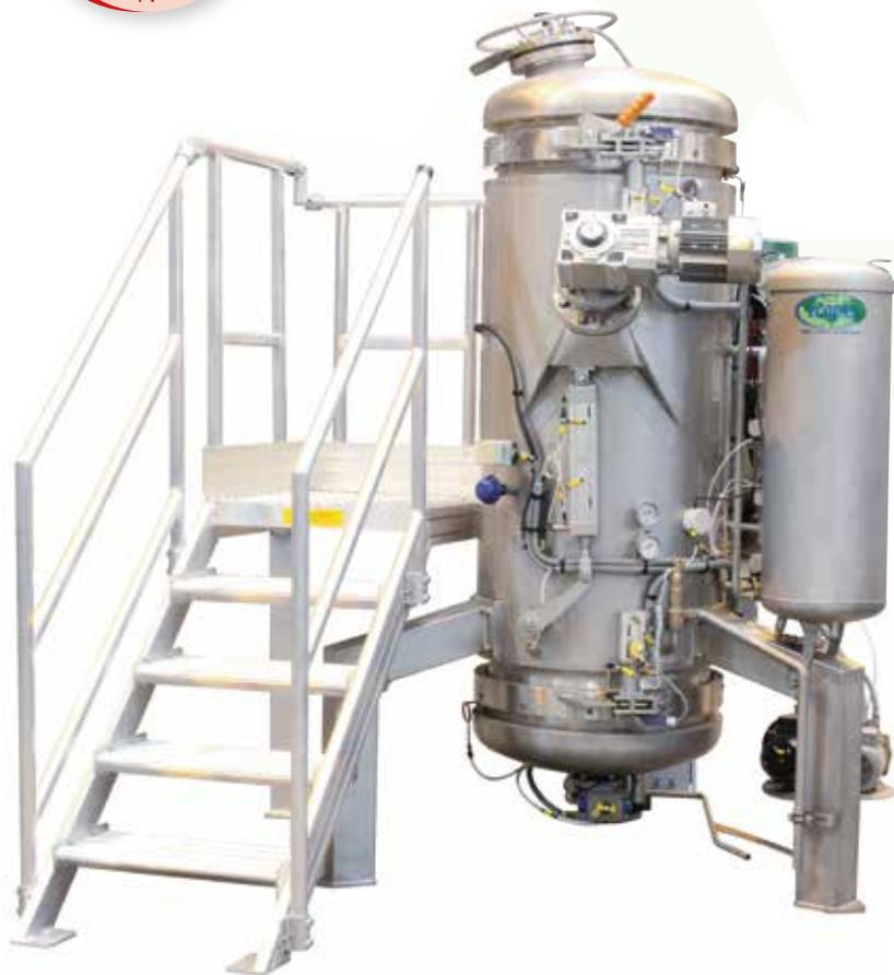
Les déchets contaminés sont introduits dans la chambre supérieure de la machine munie d'un broyeur à haute résistance. Les déchets sont broyés et acheminés, par gravité, vers la chambre inférieure.
